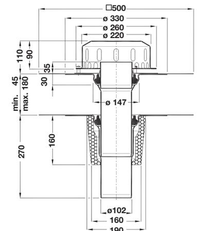
**Begleitheizung:** Wir empfehlen, nach Prüfung Dachabläufe und Leitungen in frostgefährdeten Bereichen gegebenenfalls mit einer bauseitigen Begleitheizung zu versehen.
