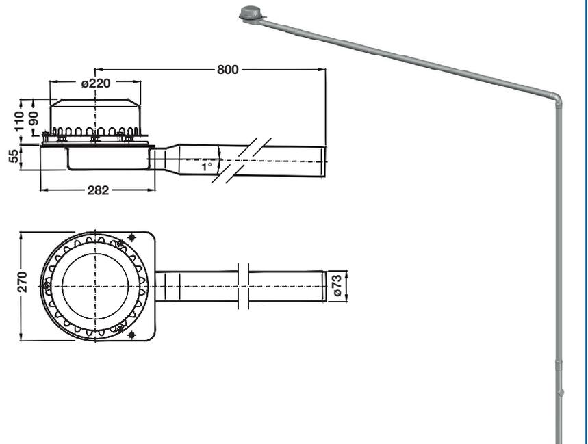
**Begleitheizung:** Wir empfehlen, nach Prüfung Dachabläufe und Leitungen in frostgefährdeten Bereichen gegebenenfalls mit einer bauseitigen Begleitheizung zu versehen.
