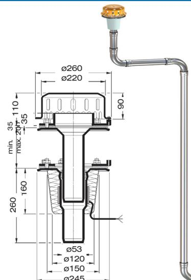
**Begleitheizung:** Wir empfehlen, nach Prüfung Dachabläufe und Leitungen in frostgefährdeten Bereichen gegebenenfalls mit einer bauseitigen Begleitheizung zu versehen.
