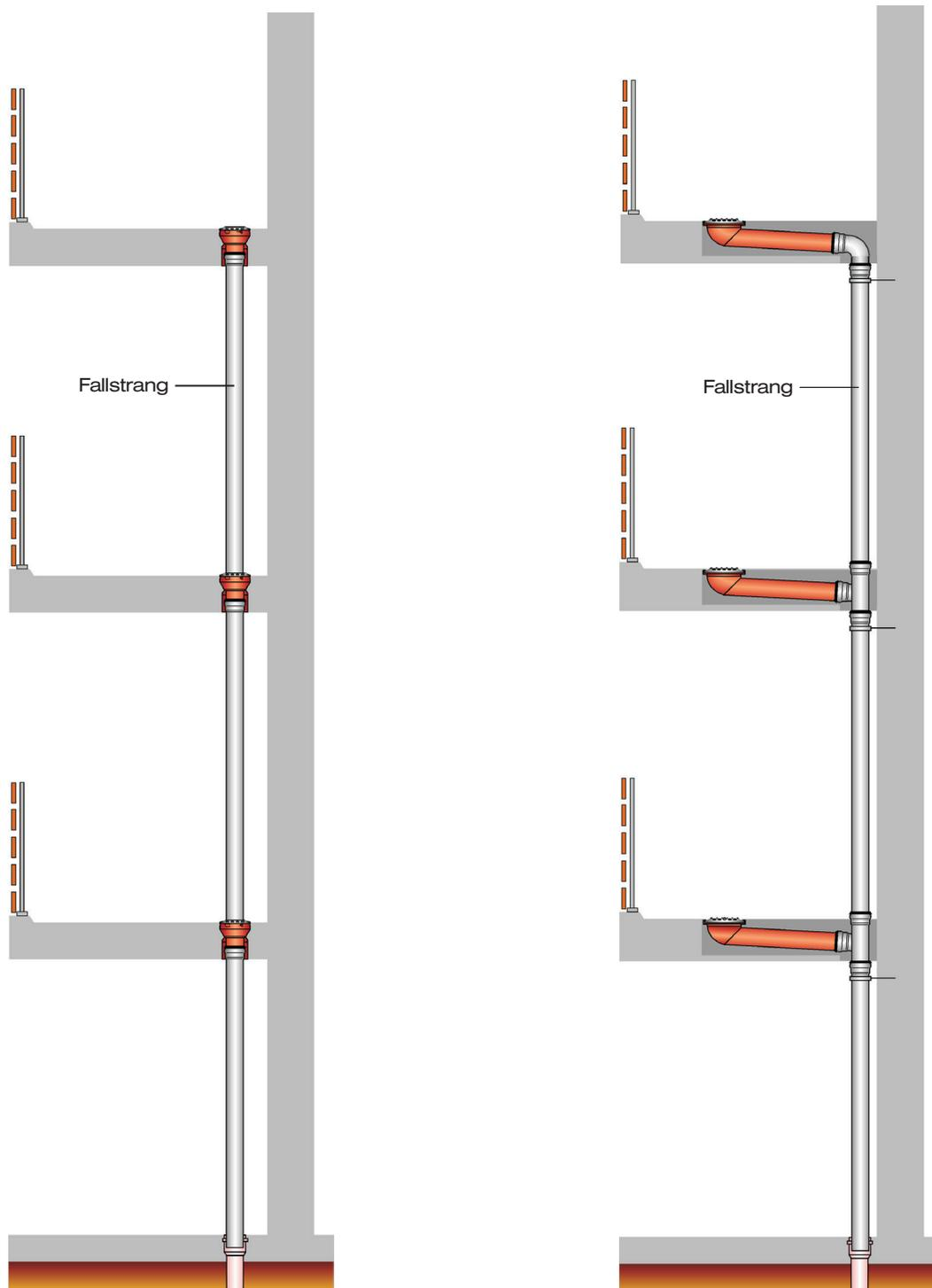
Balkone aus Betonfertigteilen aus wasserundurchlässigem Beton, ohne zusätzlichen Belag.
