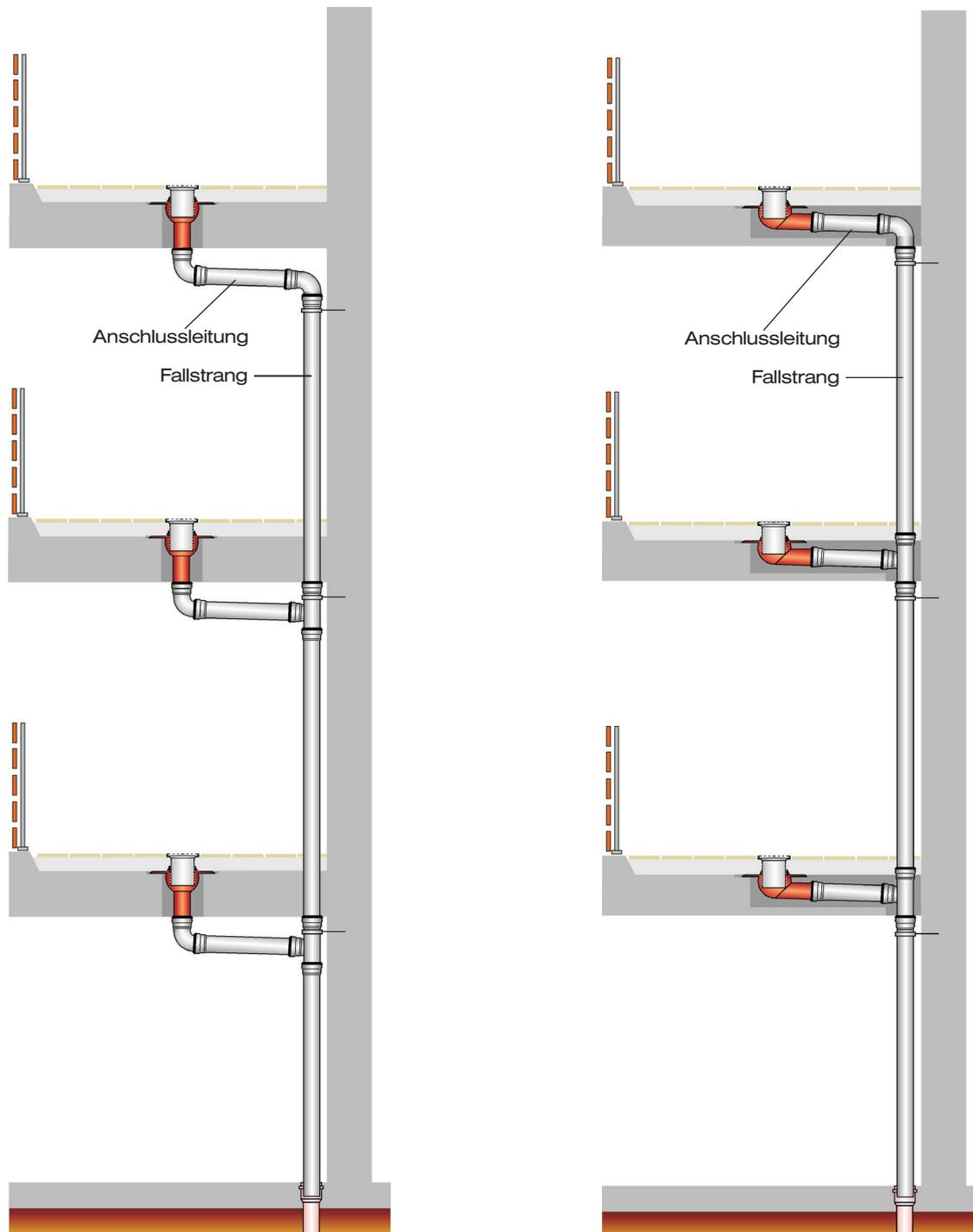
Balkonplatte mit Fliesenbelag im Mörtelbett, ohne Abdichtungsbahn, ohne Wärmedämmung.
