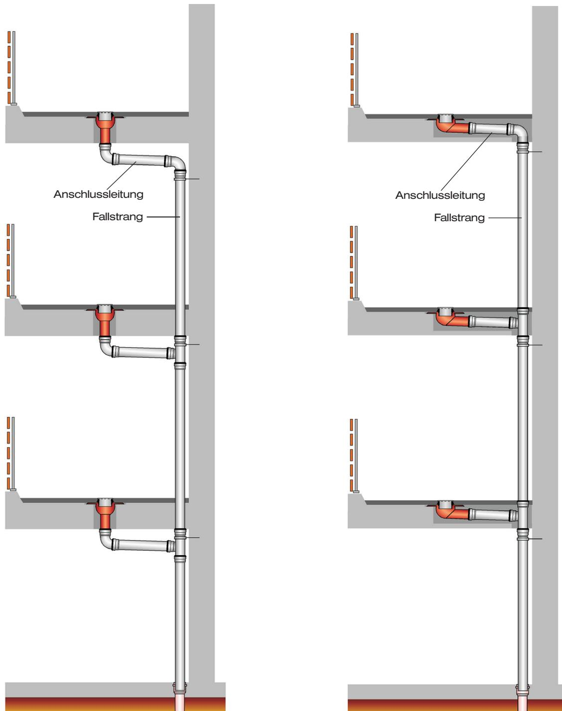
Balkonplatte mit Gussasphalt oder Fertigestrich, ohne Abdichtungsbahn, ohne Wärmedämmung.
