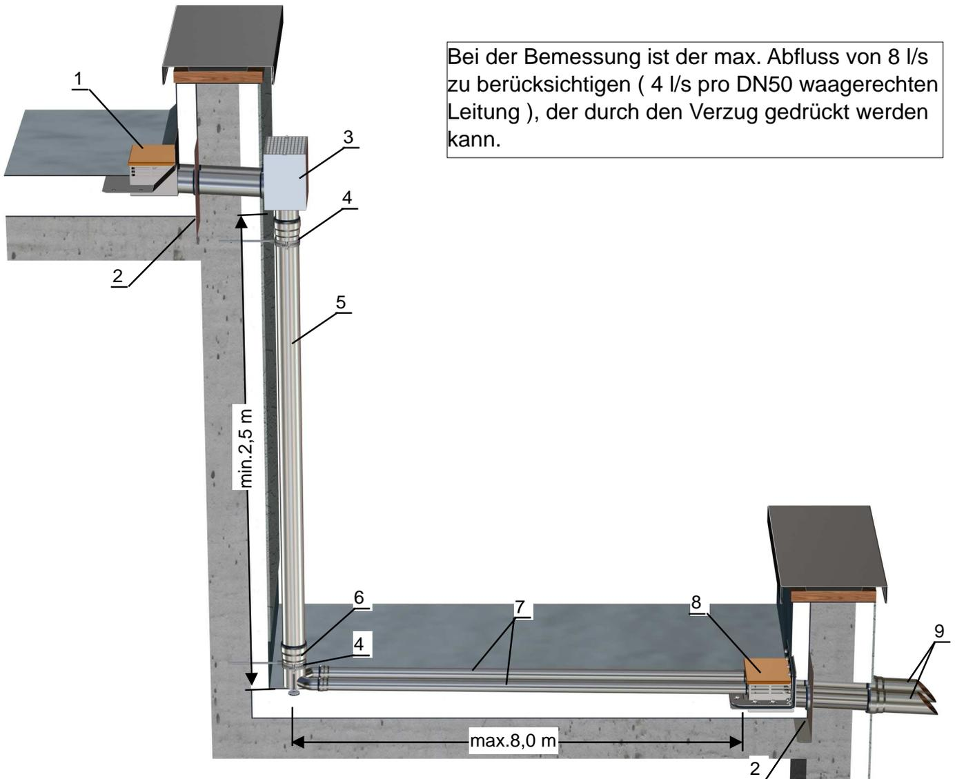
Bei der Bemessung ist der max. Abfluss von 8 l/s zu berücksichtigen ( 4 l/s pro DN50 waagerechten Leitung ), der durch den Verzug gedrückt werden kann.
