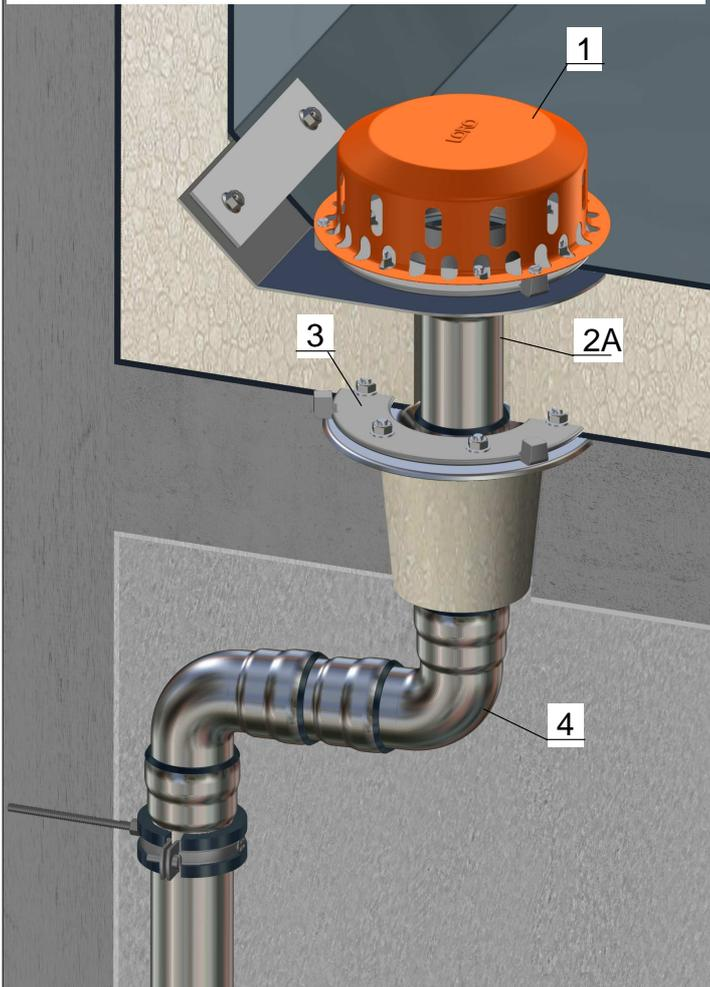
Bild 10. DRAINLET Attika-Notablauf senkrecht für Folienbahnen
