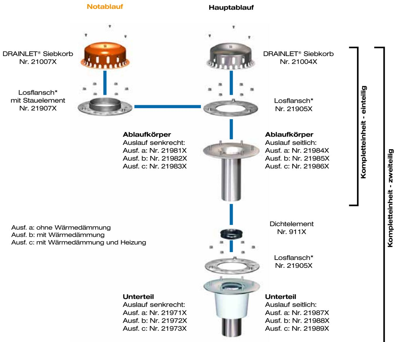
\* Einschließlich Kompressionsdichtung aus Perbunan, kann bei Verwendung von Bitumen-Dachdichtungsbahnen entfallen.
