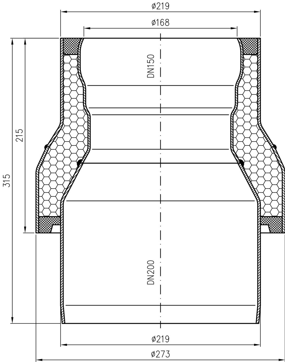
Rohrende leicht eingezogen Außenrohr: P235 TR1 EN10217-1
