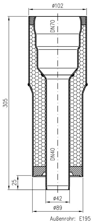
Außenrohr: E195 EN10305 feuerverzinkt Innenrohr: E195 EN10305 feuerverzinkt
