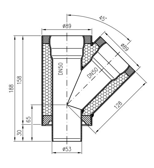
Außenrohr: E195 EN10305 feuerverzinkt Innenrohr: E195 EN10305 feuerverzinkt
