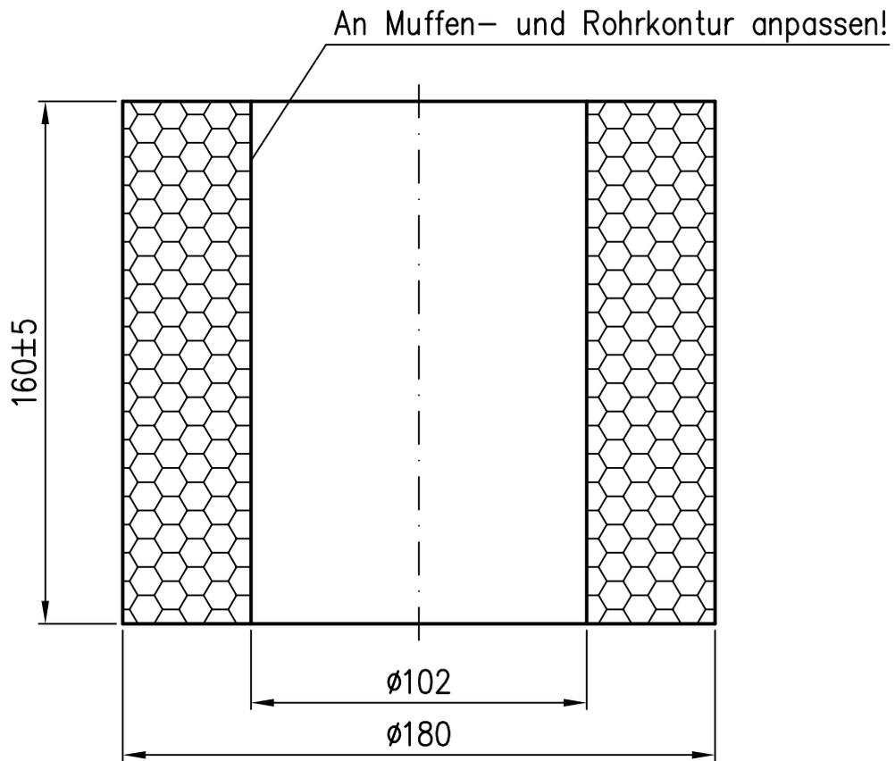
Dämmung: Conlit-Schale 150 U, Typ 102/39
