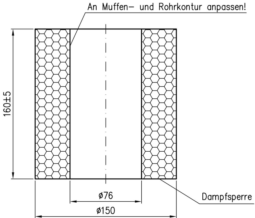
Dämmung: Conlit-Schale 150 U, Typ 76/37
