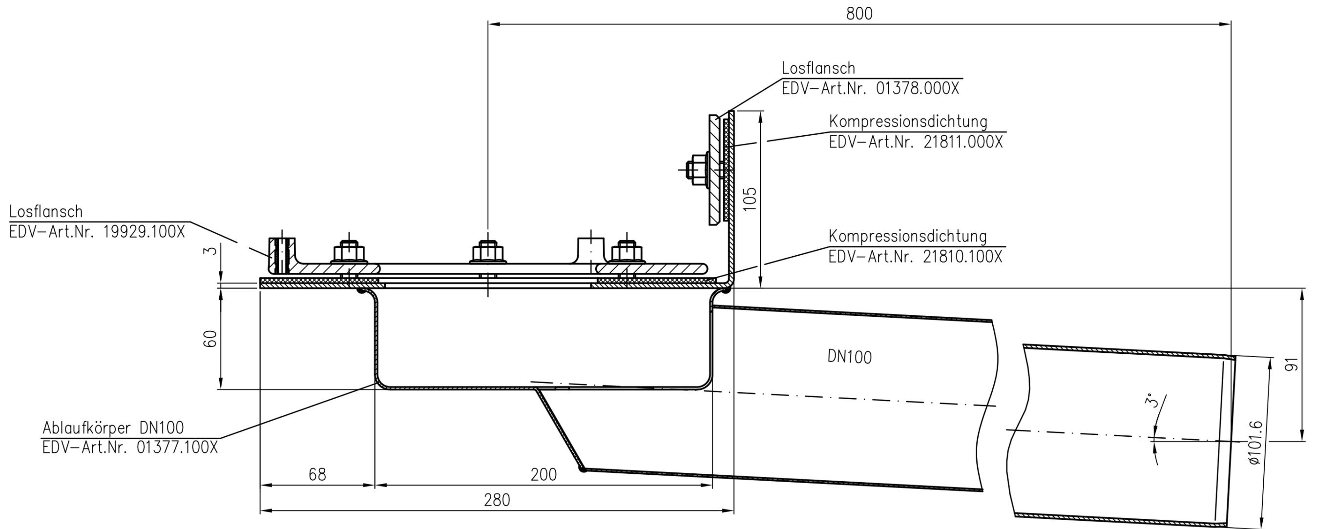
Spaltbreite zwischen Fest- und Losflansch ohne Dichtung max. 3.5mm
