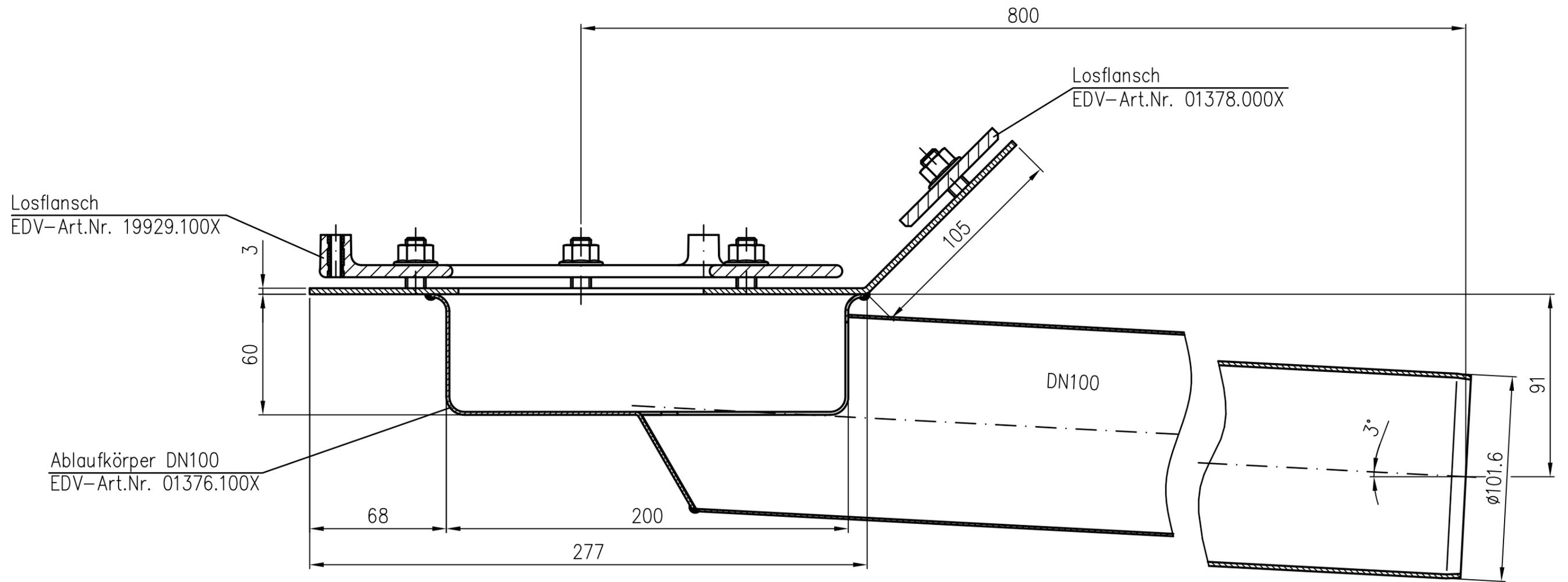
Spaltbreite zwischen Fest- und Losflansch ohne Dichtung max. 3.5mm
