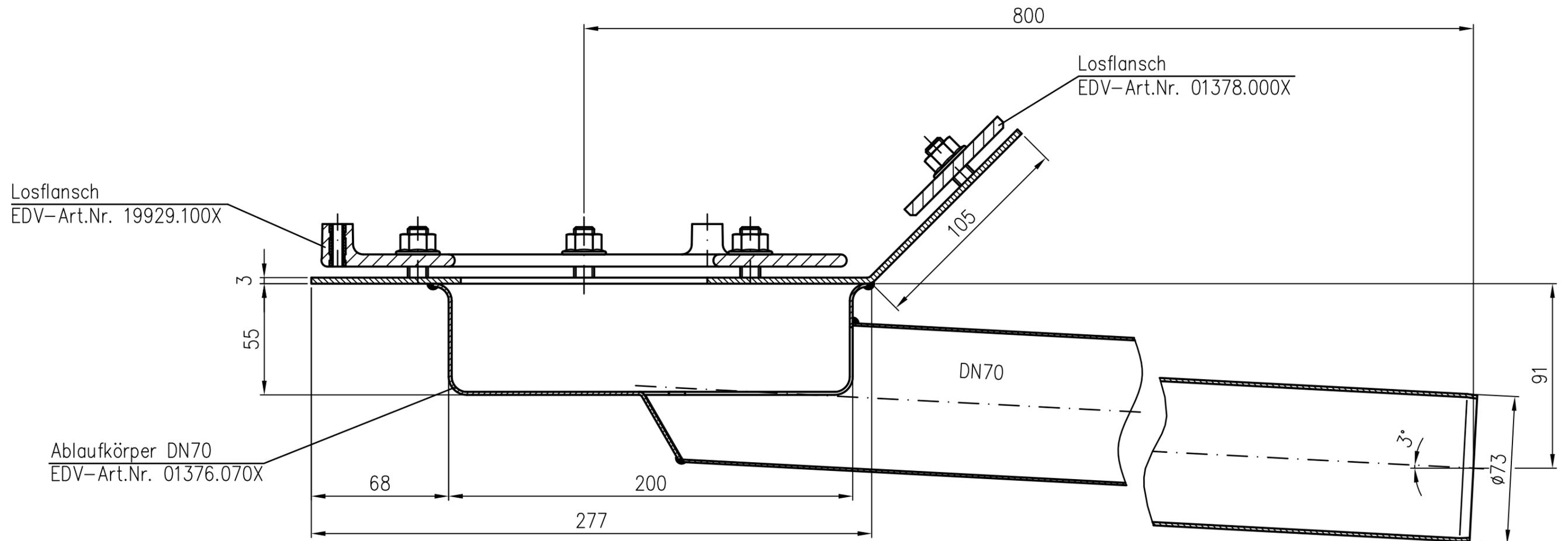
Spaltbreite zwischen Fest- und Losflansch ohne Dichtung max. 3.5mm
