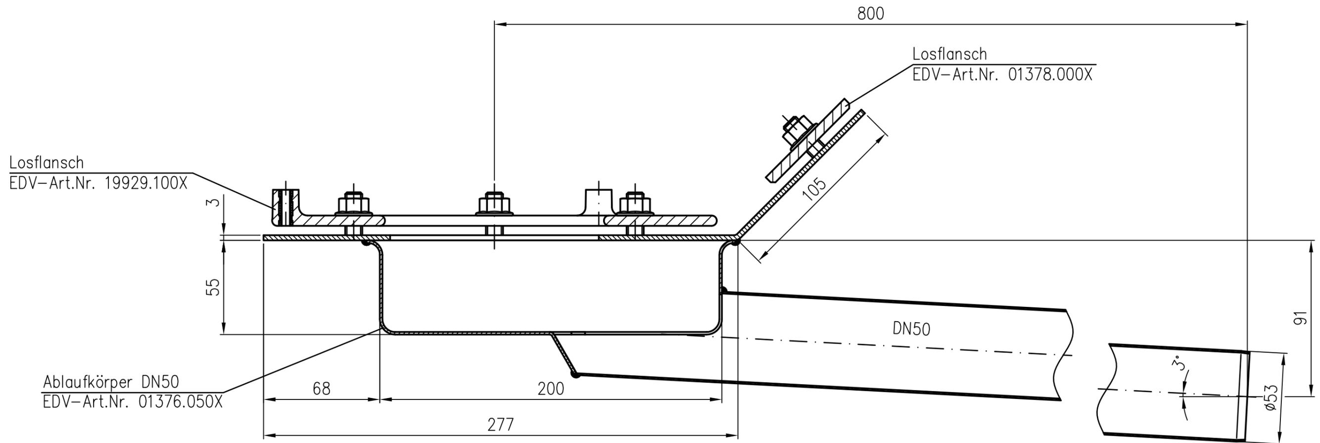
Spaltbreite zwischen Fest- und Losflansch ohne Dichtung max. 3.5mm
