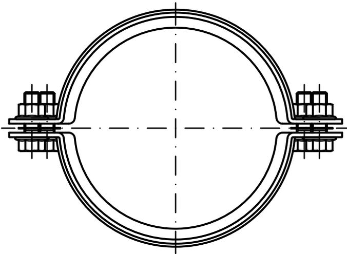
Werkstoff: Feuerverzinktes Spaltband DX51D+Z 275 MA C
