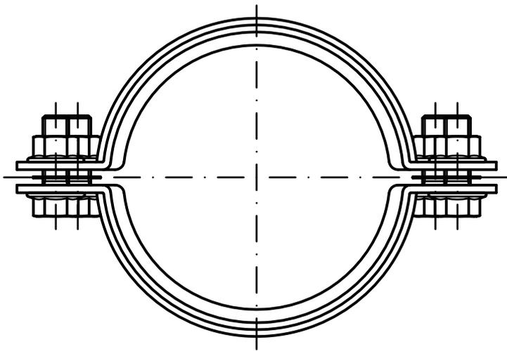
Werkstoff: Feuerverzinktes Spaltband DX51D+Z 275 MA C
