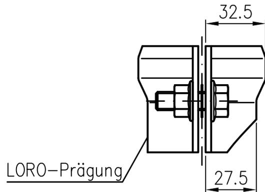
Werkstoff: Feuerverzinktes Spaltband DX51D+Z 275 MA C
