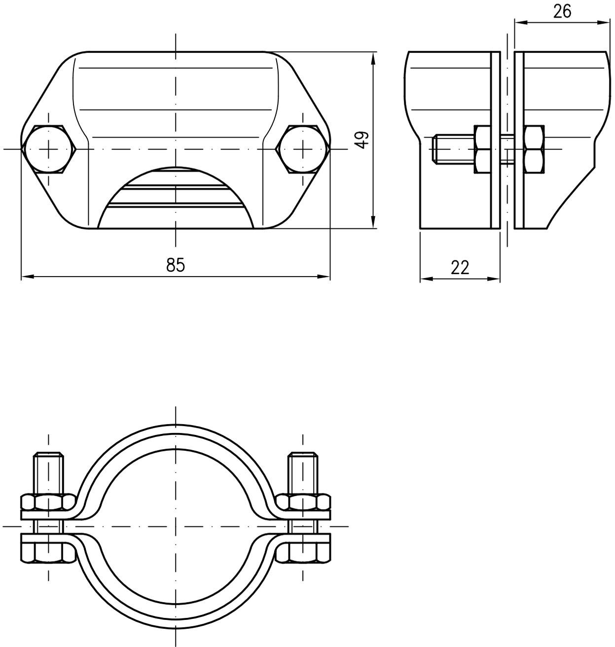
Werkstoff: Feuerverzinktes Spaltband DX51D+Z 275 MA C
