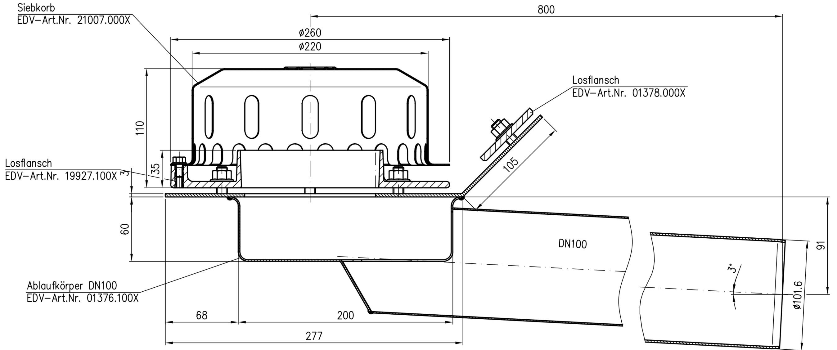
Spaltbreite zwischen Fest- und Losflansch ohne Dichtung max. 3.5mm
