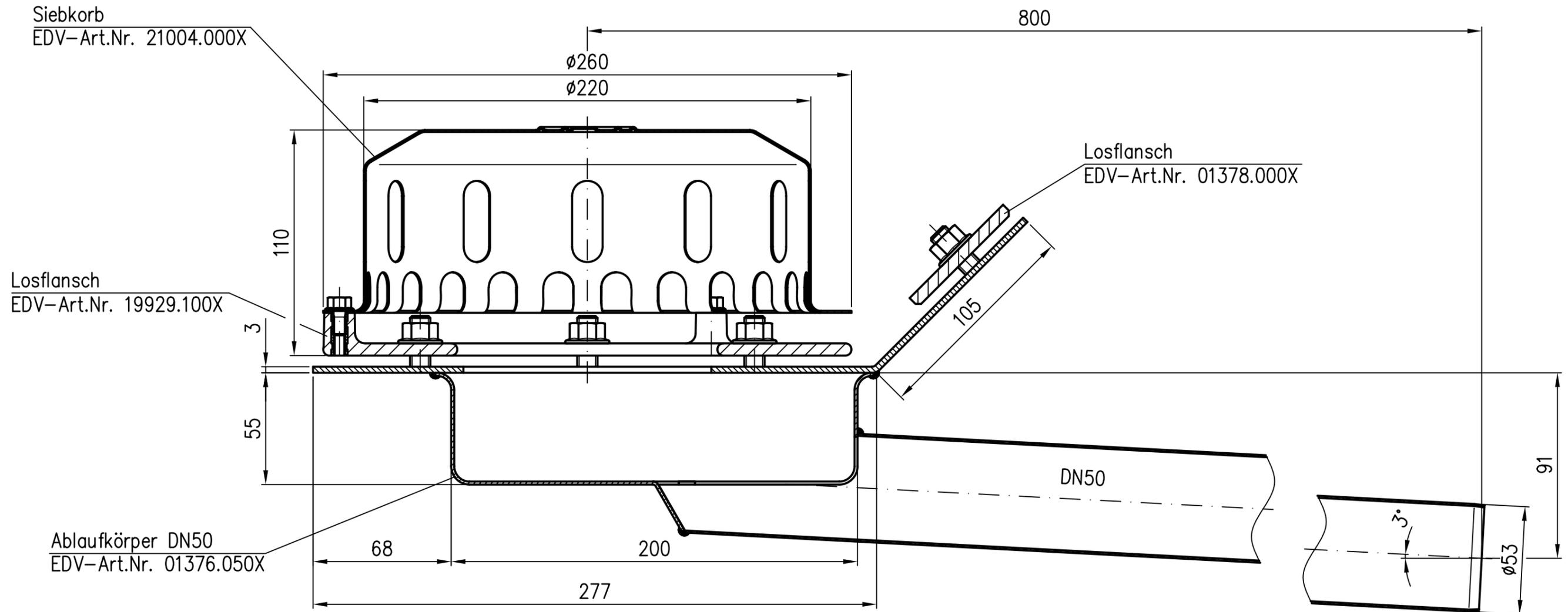
Spaltbreite zwischen Fest- und Losflansch ohne Dichtung max. 3.5mm
