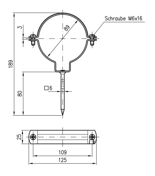
Werkstoff: St37 Dickschichtpassiviert
