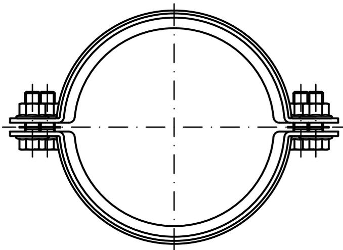
Werkstoff: Feuerverzinktes Spaltband DX51D+Z 275 MA C
