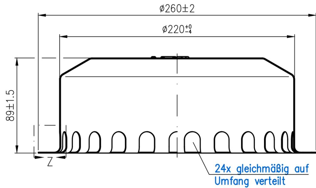
Bohrung  $\varnothing 8\text{mm}$
