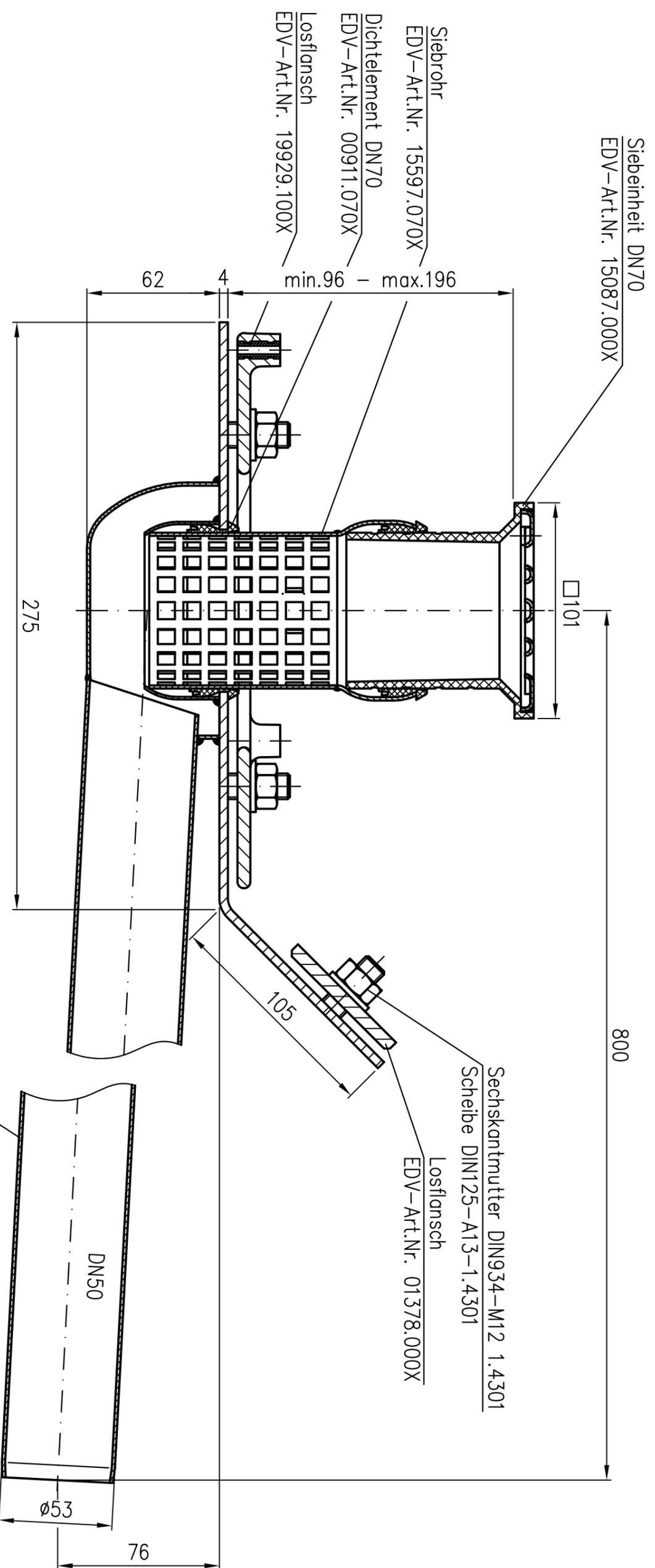
Spaltbreite zwischen Fest- und Losflansch ohne Dichtung max. 3.5mm
