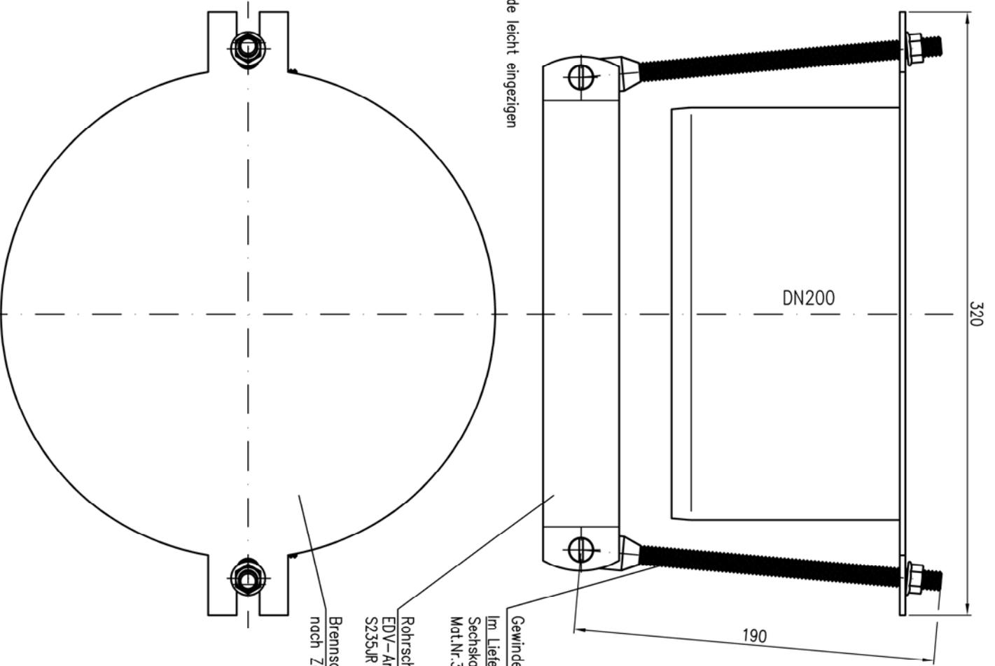
Gewindestange M10 mit angeformter Öse, 1.4301
