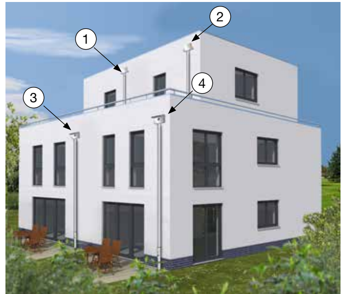
Bild 1. Vier Falleleitungen in der Hauptansicht
